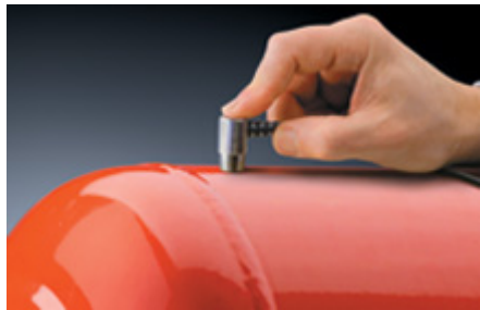
Pomoću PT-UTG ME moguće mjerenje kroz gornje slojeve (lak i boja ne mora se uklanjati)
